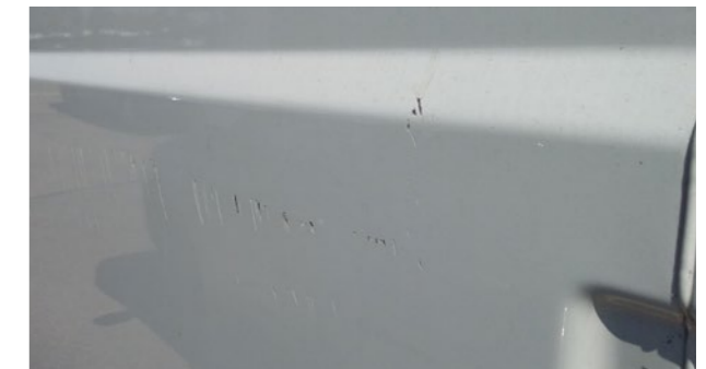
Kratzer > 20 mm Bitte beachten: Bei den hinteren Schwenktüren ist es nicht möglich, nur eine zu lackieren
