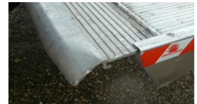
Ladebordwand: Deformationen der Plattform, die auf wirtschaftliche Weise repariert werden können
