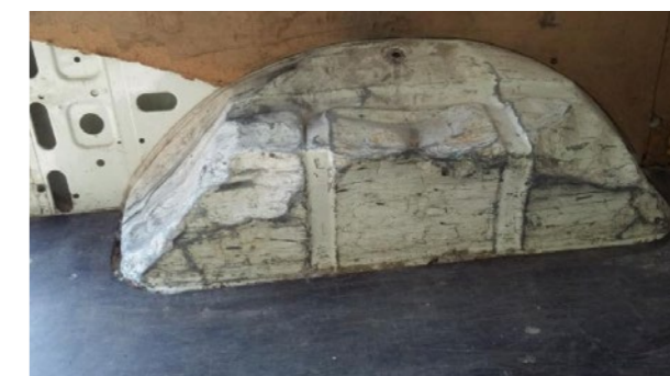
Innere Verformungen: Durchdringungen, Schnitte, Verformungen, die nicht auf wirtschaftliche Weise repariert werden können. Stoffverändernde und nicht entfernbare Ablagerungen (Pulver, Lackfarbe usw.) (Radkasten nicht wiederherstellbar, wenn Reparaturzeit < 3h)
