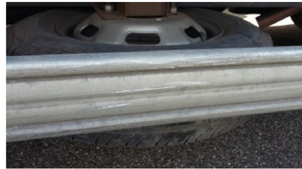
Seitenunterfahrerschutz: Leichte Kratzer
