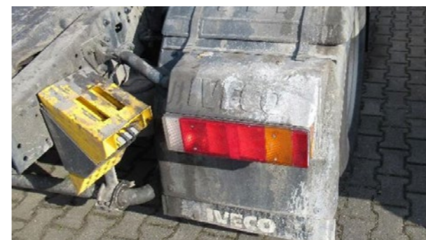
🔄 Décoloration importante due à des éléments chimiques
