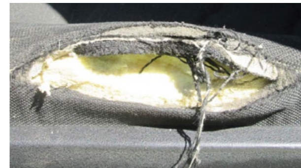
Manque de mousse ou structure cassée
