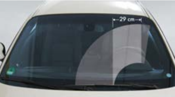
Opmerking: Het zichtveld wordt bepaald door een vel A3 papier in het verlengde van de stuurwielas en verticaal gecentreerd op de voorruit.
