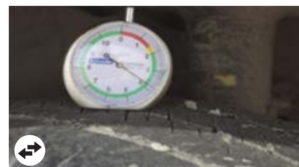
Banden: Diepte van basisprofielgroef < 5 mm Opmerking: De slijtage van de banden wordt gemeten in de meest versleten groef van de band.
