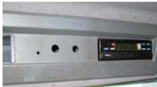
Bedieningsonderdelen, onderdelen van stoelen of bekleding ontbreken, gebroken of doorboord
