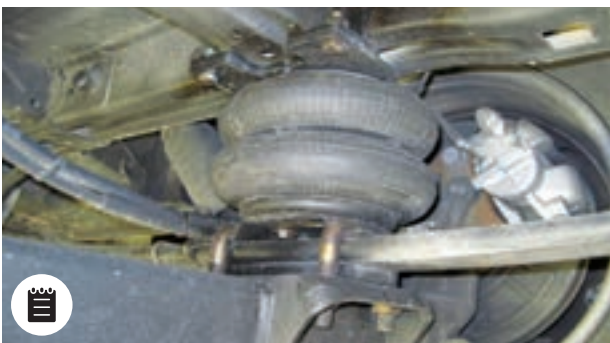
Lichte sporen van olie (niet druppelen)
