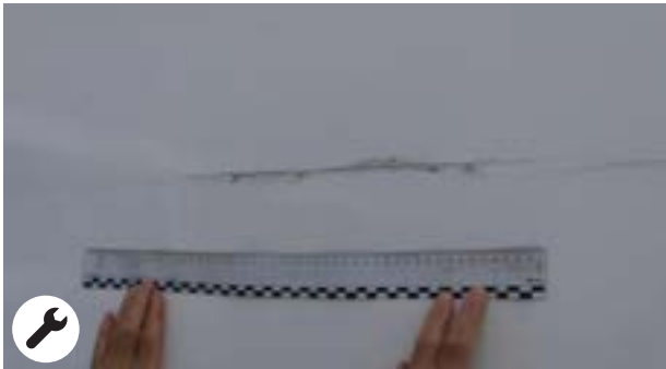
Zijpanelen: Kras met verwijderd materiaal ≥ 10 cm nog economisch verantwoord te repareren. Optie om half paneel te spuiten
