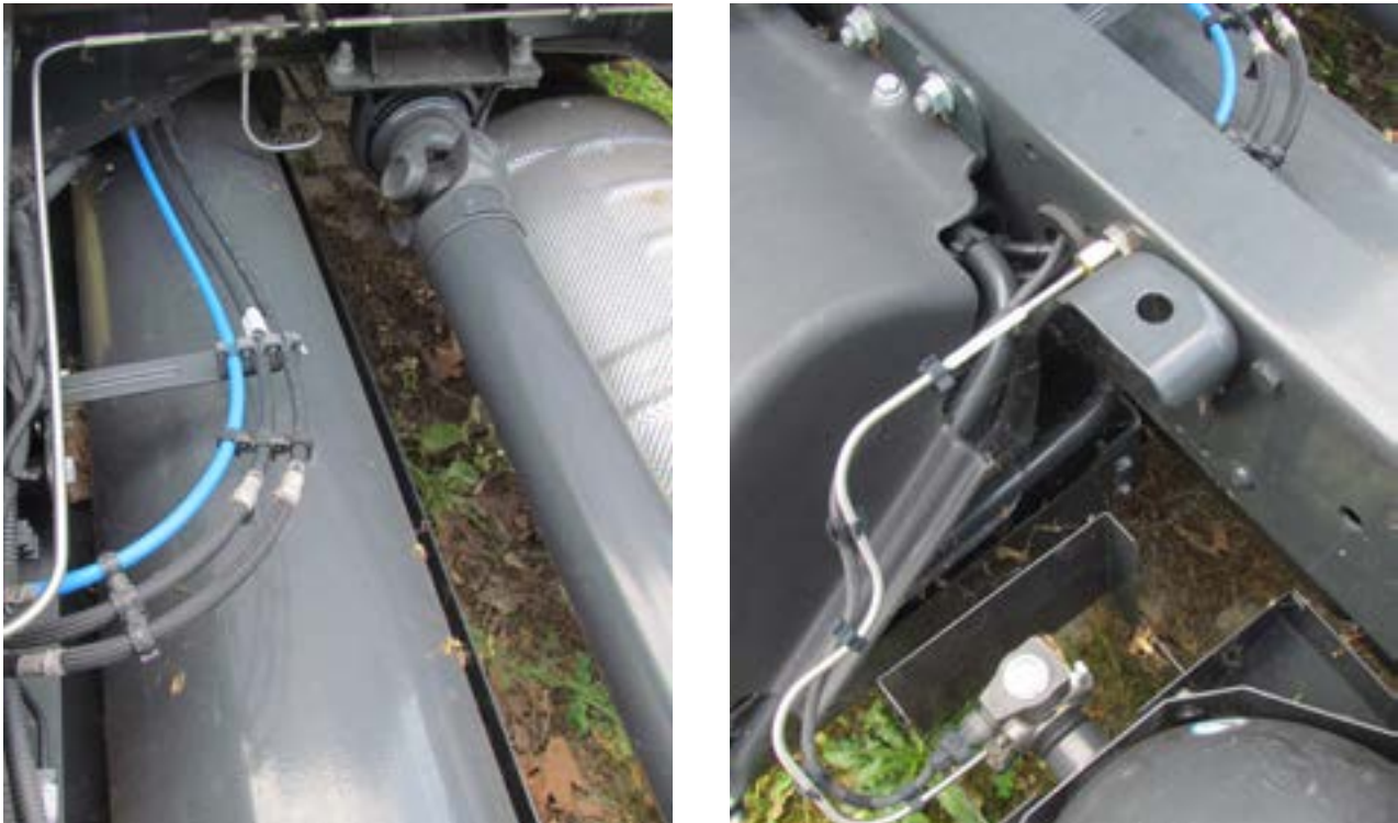
Controleer de status van de benzineleidingen (geen lekkages, geen tekenen van diepe krassen). Brandstofleidingen moeten in goede staat worden geretourneerd, zoals afgebeeld op de afbeelding
