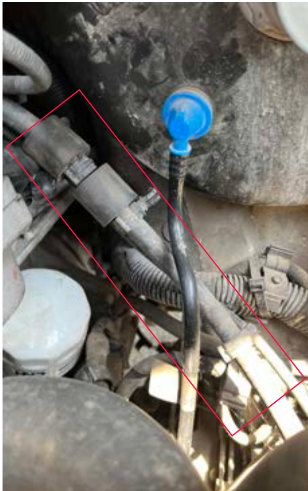
Beschadigingen/krassen • vergoeding voor vervanging middendrukleiding.
