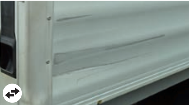
Vervormingen in de body afdichtingen indien > of = 10 cm, sluiting niet mogelijk of niet schuurbaar
