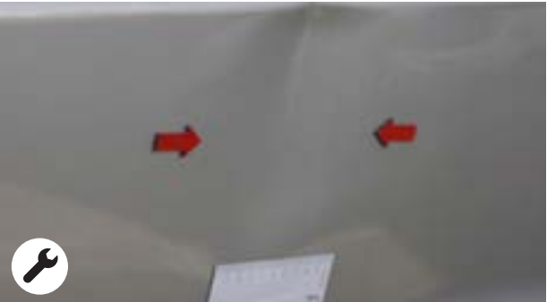
Deuken > 20 mm in diameter, veranderde lak, hagelschade of duidelijke putten NB: Smart repair mogelijk bij individuele, duidelijke putjes als de lak niet wordt gewijzigd
