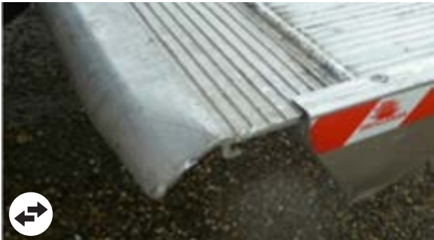
Laadklep: Vervormingen van laadklep economisch verantwoord te repareren
