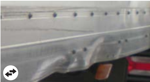
Zijdorpels: Beschadiging voorbij economisch verantwoorde reparatie, perforaties, demontage van een deel van het profiel
