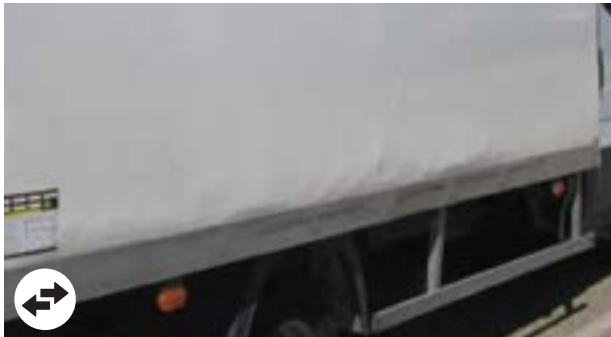
Vezel-zijpanelen: Vervorming onderste deel, lengte > 1 m NB: Vervanging van het voorste paneel van de bodemplaat vereist demontage van de bodemplaat.
