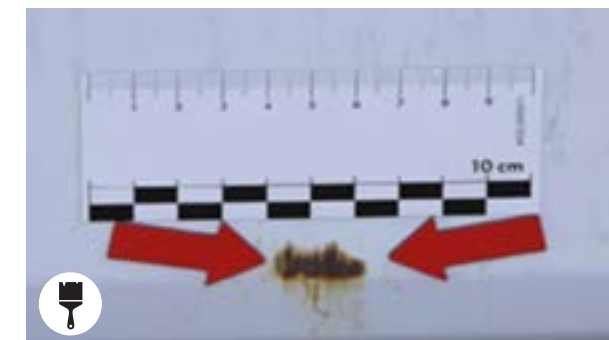
Krassen met oxidatie, chemische aanslag of anders, dat niet kan worden gereinigd
