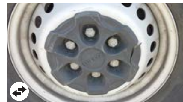
Wioldoppen: Vervormd, gebroken, materiaal ontbreekt of compleet verwijderd
