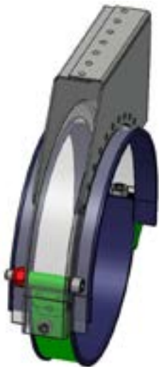
Bevestigingsband aan tankbeugel: controleer de status van componenten (oxidatie, schade, enz.)
