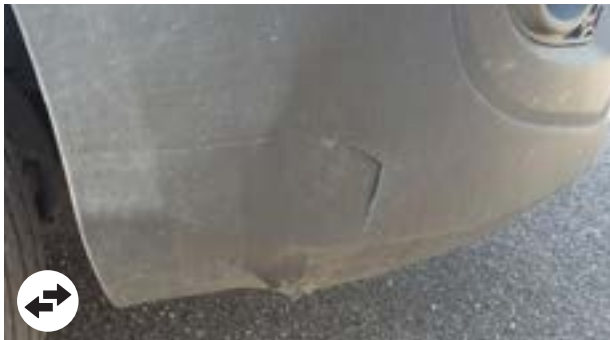
Defect, verwijderen van materiaal of vervorming niet economisch te repareren of niet haalbaar
