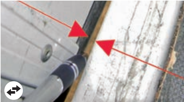
Vervormingen in de body afdichtingen indien > of = 10 cm, sluiting niet mogelijk of niet schuurbaar
